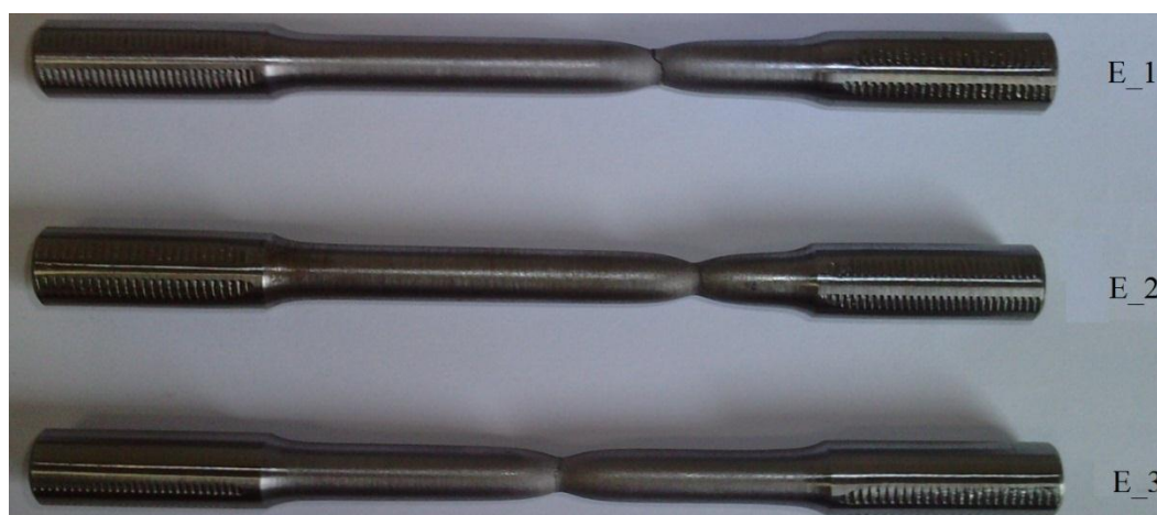
Slika 60. Epruvete nakon ispitivanja
