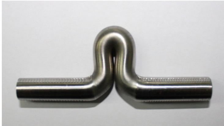
Slika 65. Epruveta opterećena velikom tlačnom silom
