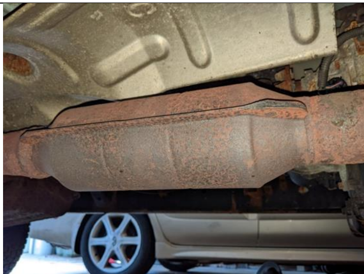
Slika 9. Opća korozija katalizatora [34]
