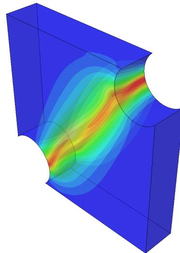
(d) Crack topology - SCA homogeneous
