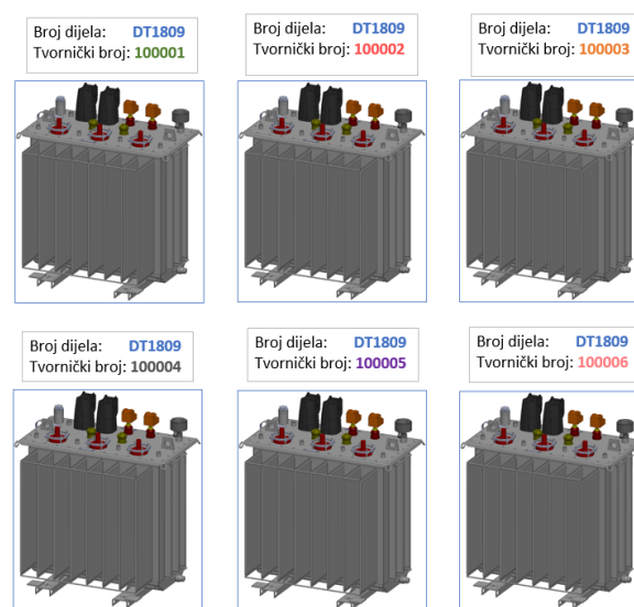
Slika 19. Logika identifikacije transformatora
