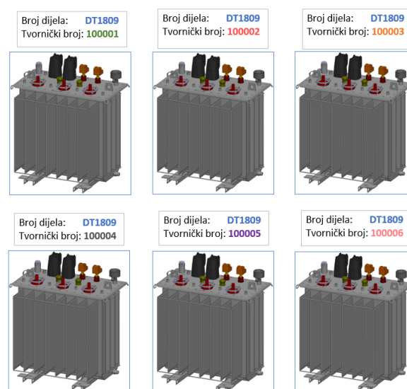
Slika 19. Logika identifikacije transformatora
