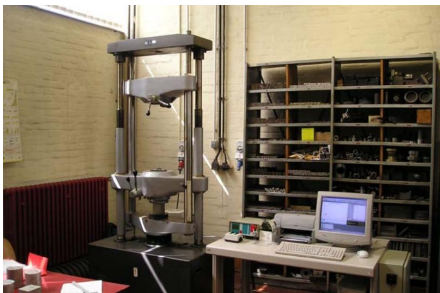
Slika 55 – Kidalica WPM EU 40 mod. na kojoj je obavljeno ispitivanje
