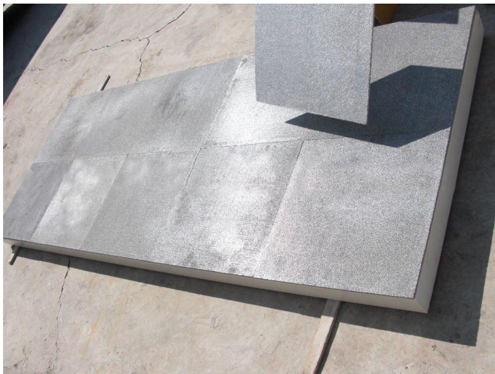
Slika 49 – Vatrootporne ploče aluminijske pjene za toplinsku izolaciju [16]
