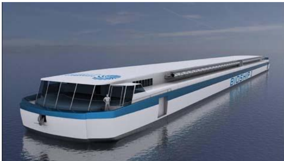
Slika 39 – Model broda Bioship1 sa dnom i oplatom trupa zamijenjenima aluminijskom pjenom te tako smanjenom težinom 30% [14]
