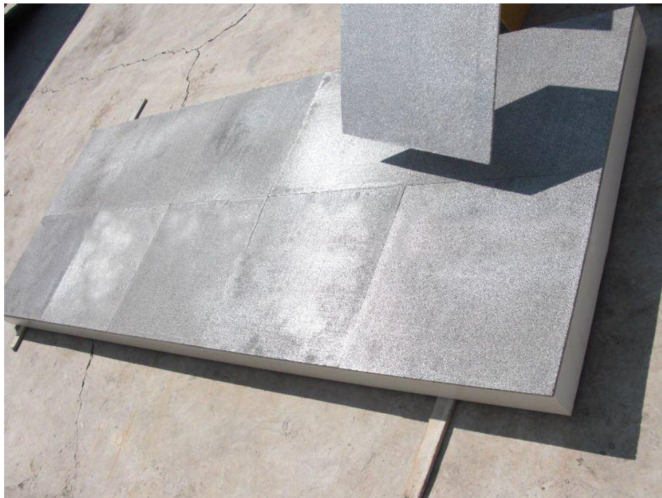
Slika 49 – Vatrootporne ploče aluminijske pjene za toplinsku izolaciju [16]
