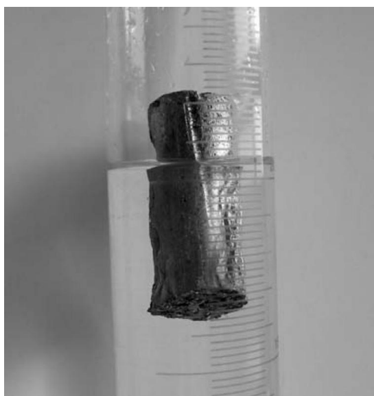
Slika 44 – Aluminijska pjena sa zatvorenim ćelijama pluta na vodi [19]
