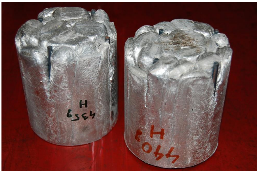
Slika 54 – Neujednačenost strukture aluminijske pjene sa „H“ tipom ojačanja
