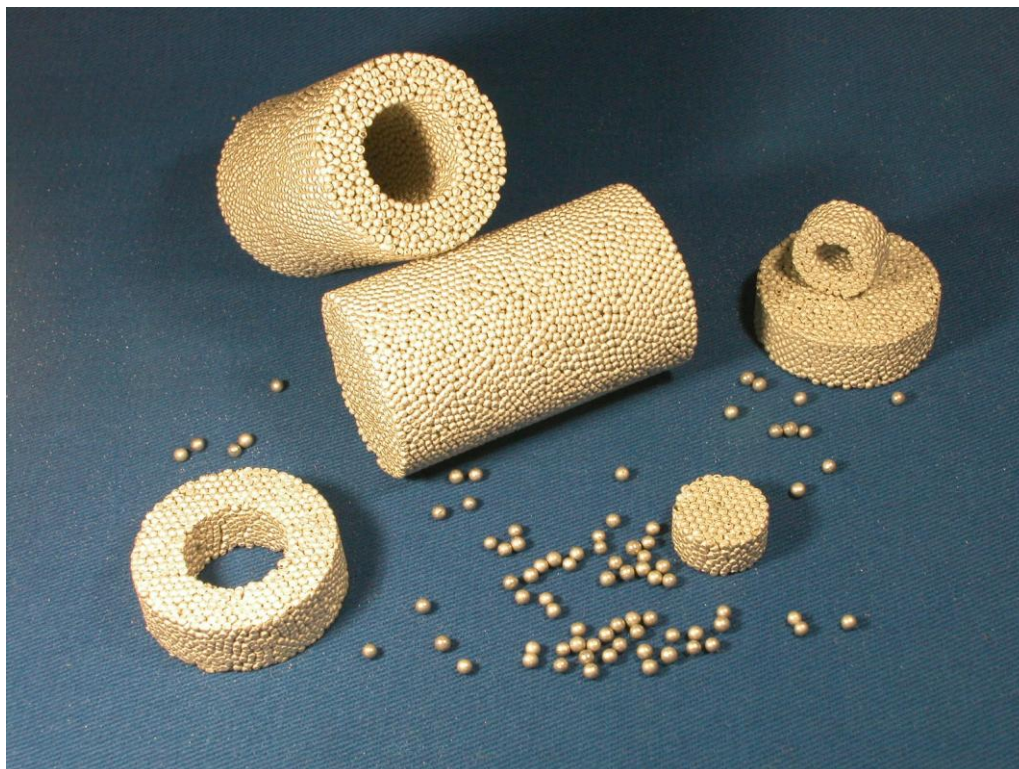
Slika 15 – Primjeri uporabe metalnih pjena s kuglastim šupljinama [7]
