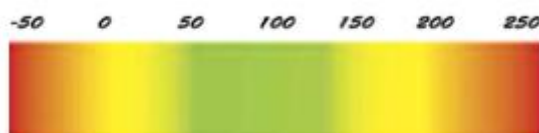
Slika 18. Područje optimalne radne temperature ležaja [18]
