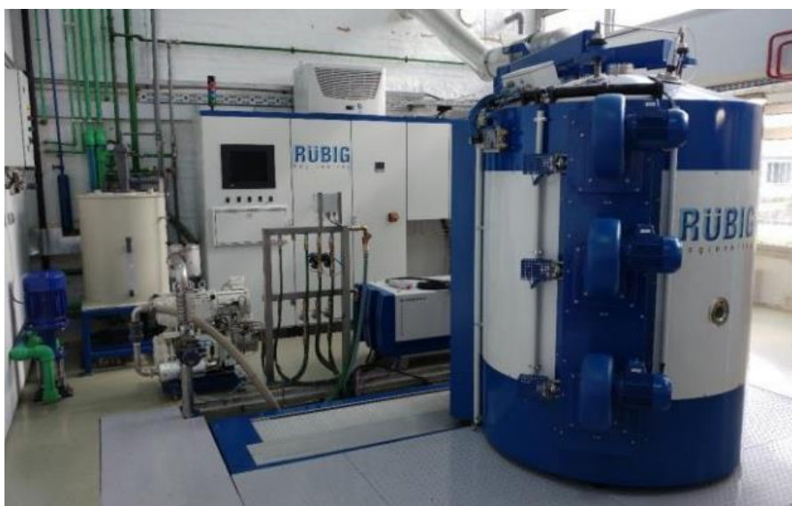
Slika 20. Peć za nitriranje u plazmi Rubig PN 70/90
