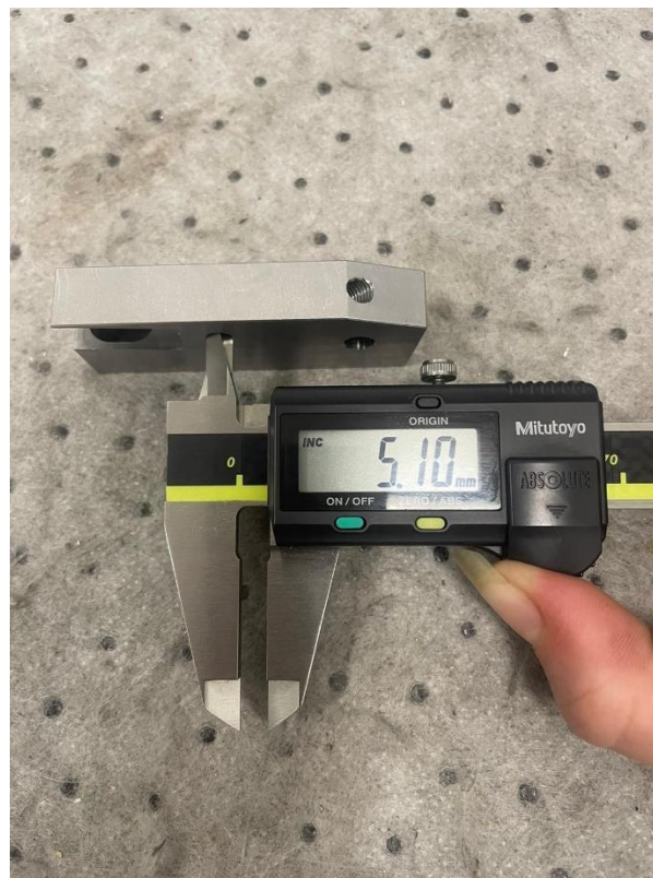
Slika 78. Mjerenje provrta 5,1 mm (broj 8)
