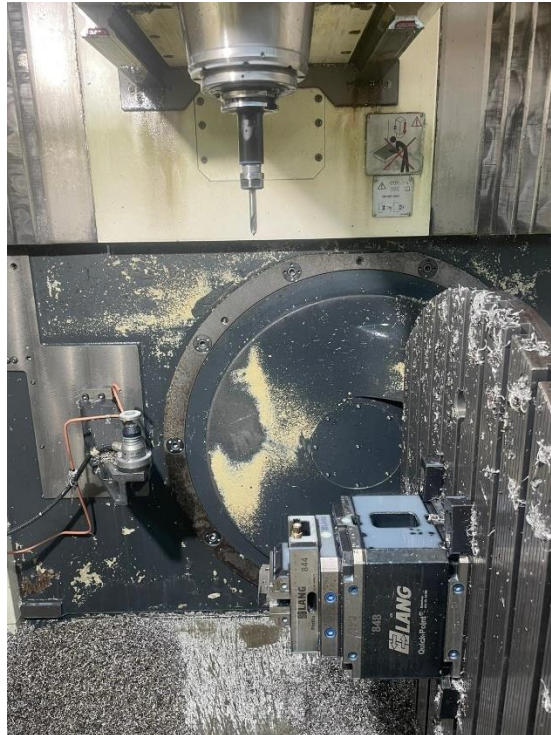
Slika 73. Zabušivanje u rotaciji
