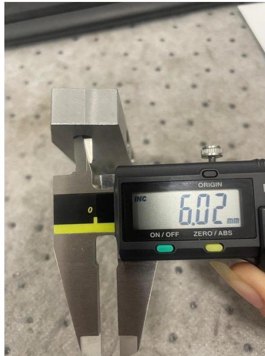
Slika 77. Mjerenje upusta 6 mm (broj 4)
