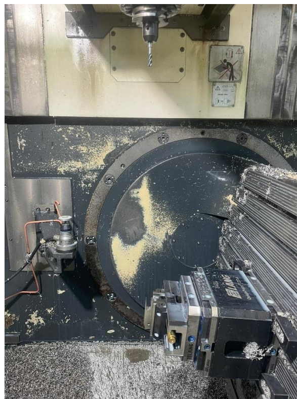
Slika 74. Izrada utora 10 mm u rotaciji
