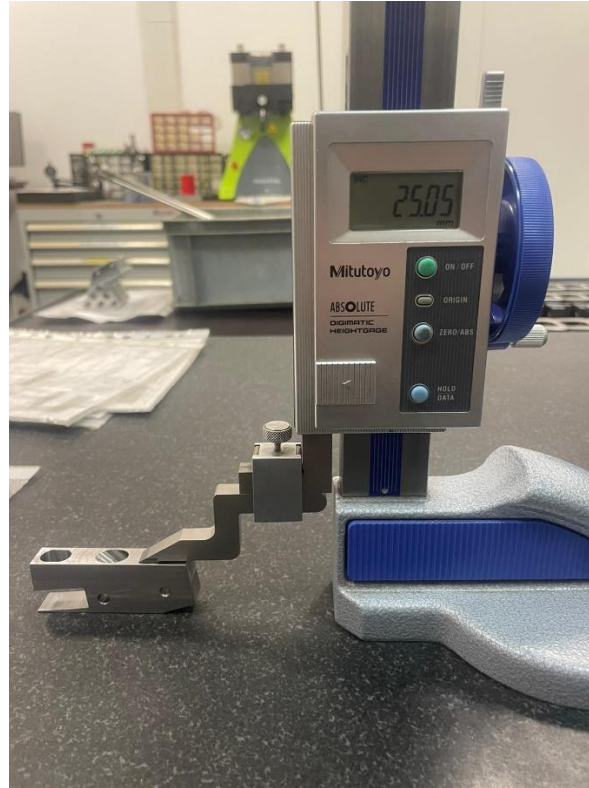
Slika 81. Mjerenje visine obratka
