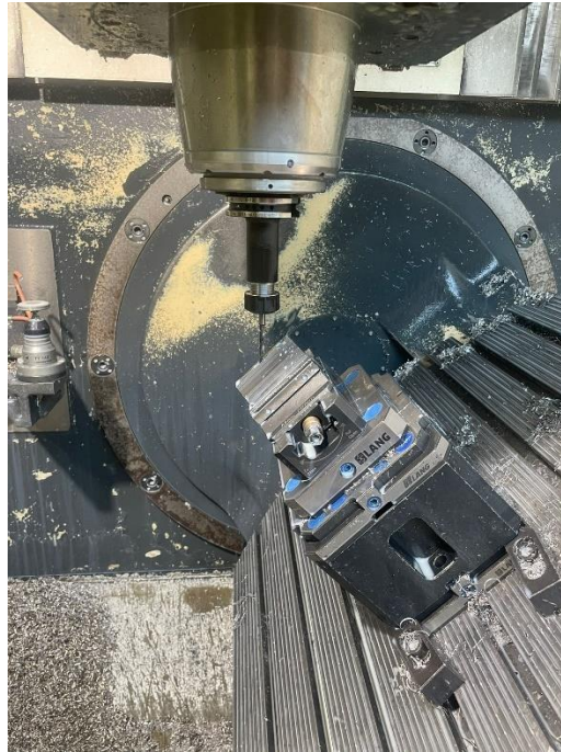
Slika 70. Bušenje svrdlom 4,3 mm u rotaciji
