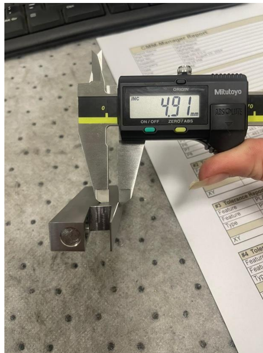
Slika 76. Položaj provrta 5,1 mm (broj 8)
