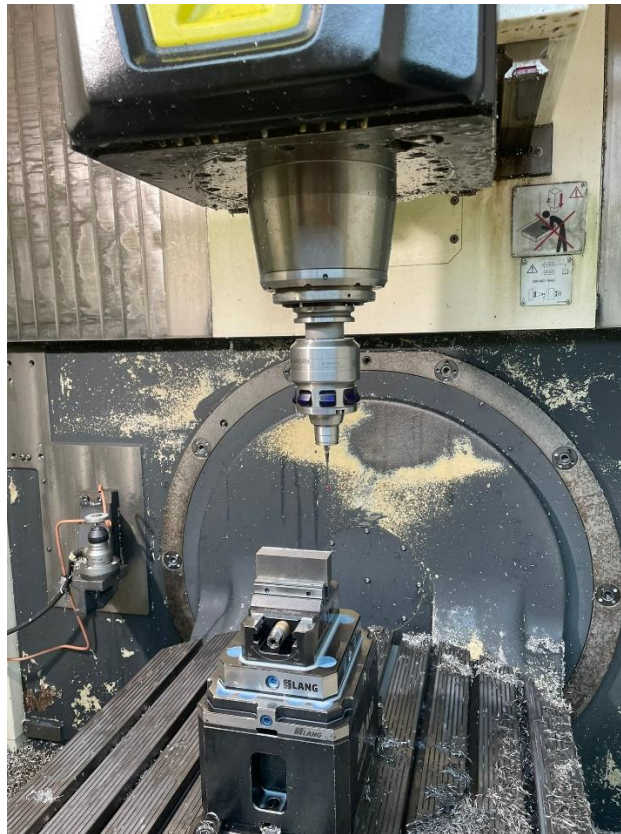
Slika 67. Pripremak i ticalo
