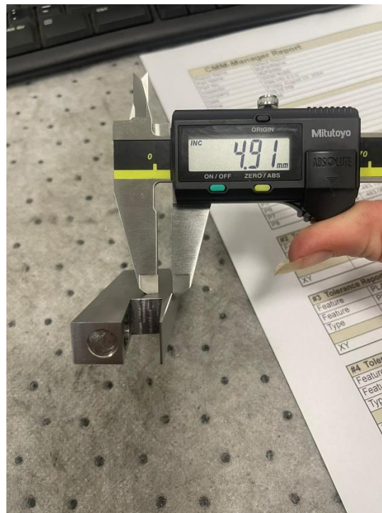
Slika 76. Položaj provrta 5,1 mm (broj 8)
