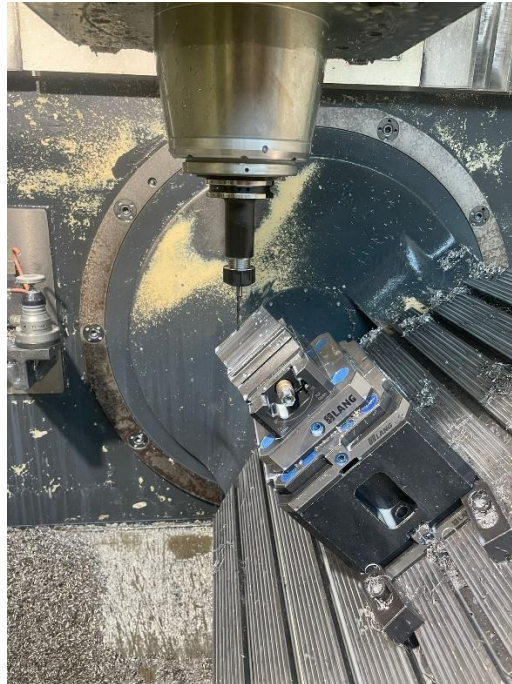
Slika 70. Bušenje svrdlom 4,3 mm u rotaciji
