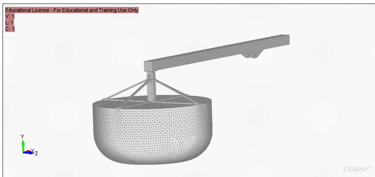
Slika 28 Prikaz generirane mreže konačnih elemenata na modelu u Femap/NX NASTRAN
