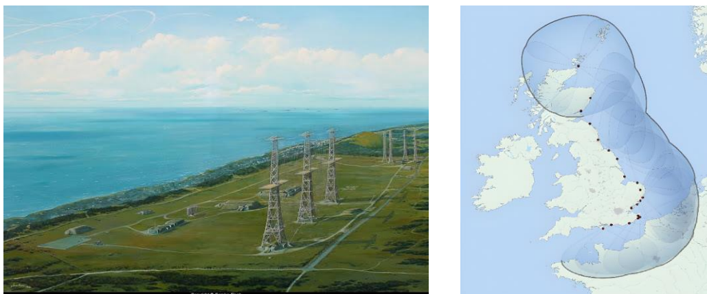
Slika 5 Ilustracija stanice „Chain Home“ sustava i njegovo pokrće obale
