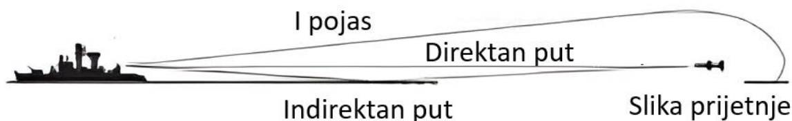
Slika 2 Radarski sustav za pronalaženje prijetnji
