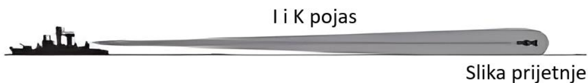
Slika 4 Radarski sustav za praćenje prijetnji
