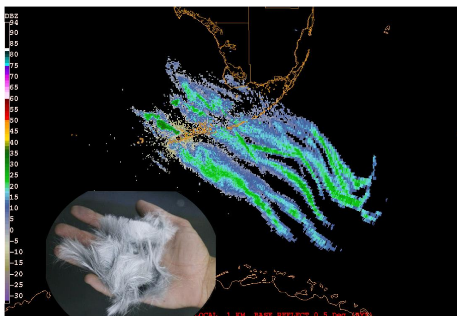
Slika 26 Osljepljenje radara i izgled dipolnih reflektora
