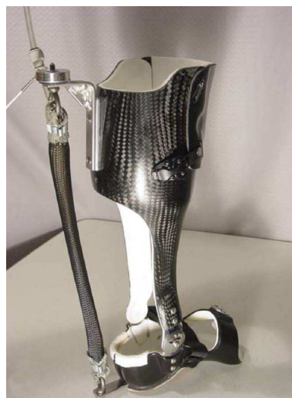
Slika 2.13. Ortoza za stopalo pokretana pneumatskim mišićem [12]
