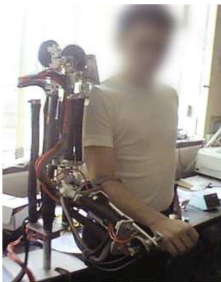
Slika 2.12. Sustav za pokretanje ljudske ruke [11]
