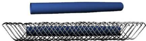
Slika 2.1. Struktura umjetnog mišića [3]
