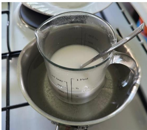
Slika 28. Otopina kalijevog hidrogenkarbonata i demineralizirane vode u loncu s vodom
