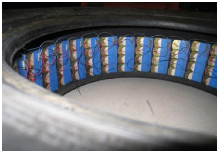
Slika 18. Niz PZT elemenata na unutrašnjosti gume [48]
