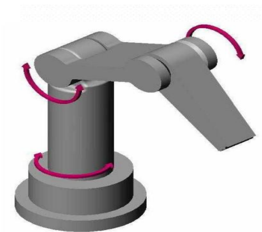
Slika 2.6. Rotacijska struktura robota[2]
