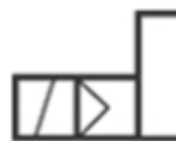
Slika 25. Simbol aktivacije elektromagnetom[17]
