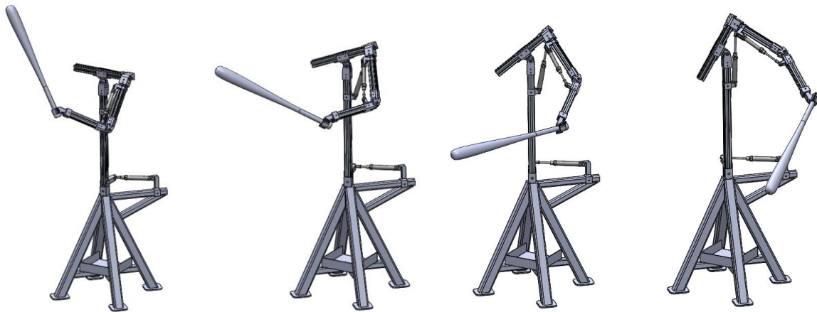
Slika 9. Faze zamaha prikazane na konceptu u Solidworksu
