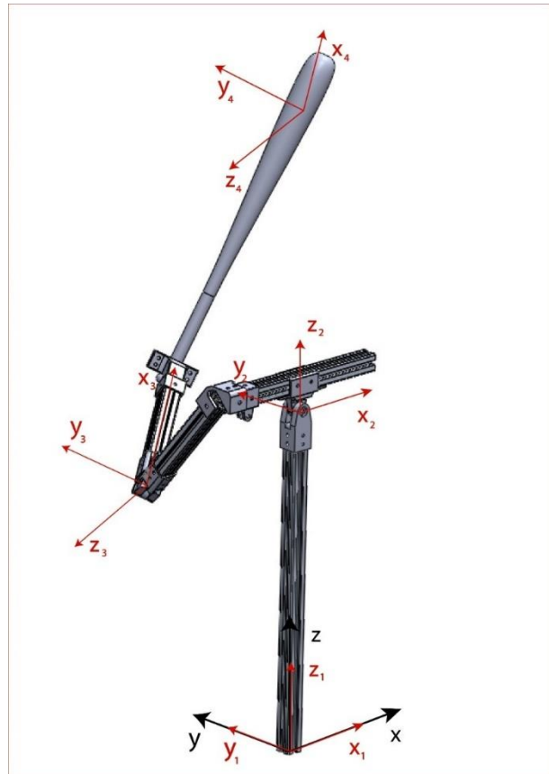
Slika 11. Prikaz pojednostavljenog modela s koordinatnim sustavima
