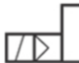
Slika 25. Simbol aktivacije elektromagnetom[17]
