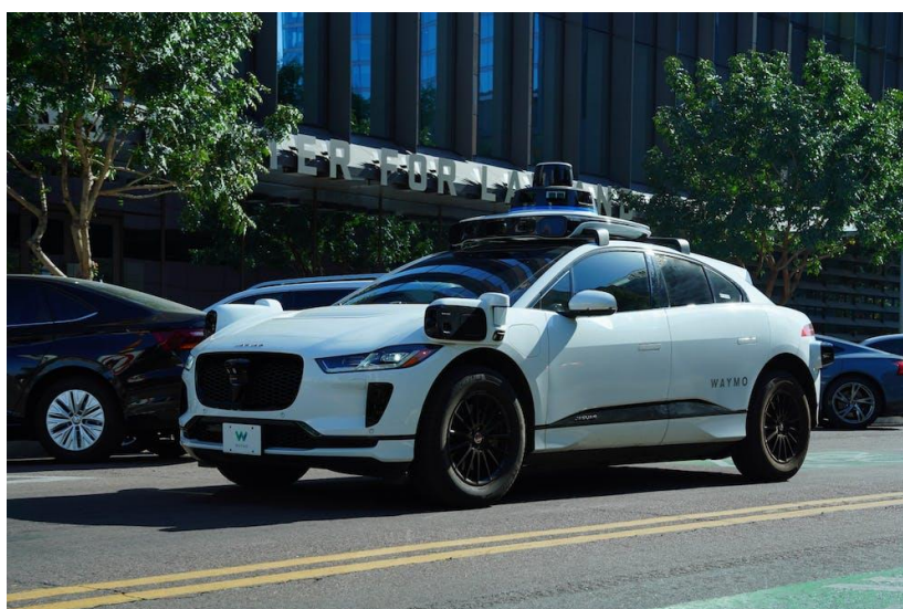
Slika 4. Autonomni automobil sa 3D LIDAR sustavom
