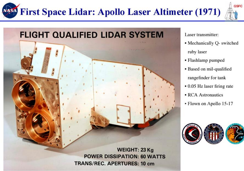
Slika 2. Apollo 15. Laserski visinomjer
