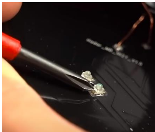
Slika 17. Fotodioda i fotoosjetljiv tranzistor RPLidara
