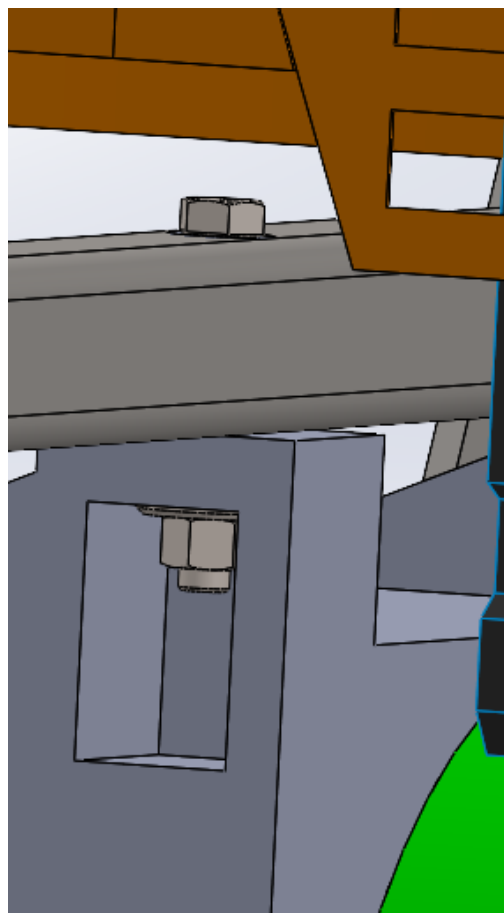
Slika 27. Veza kvadratnog profila i traktora
