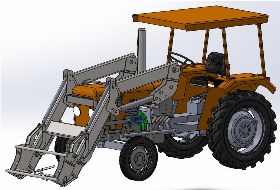
Slika 68. Sklop traktora i utovarivača kod maksimalnog povratnog kuta zakreta na zemlji
