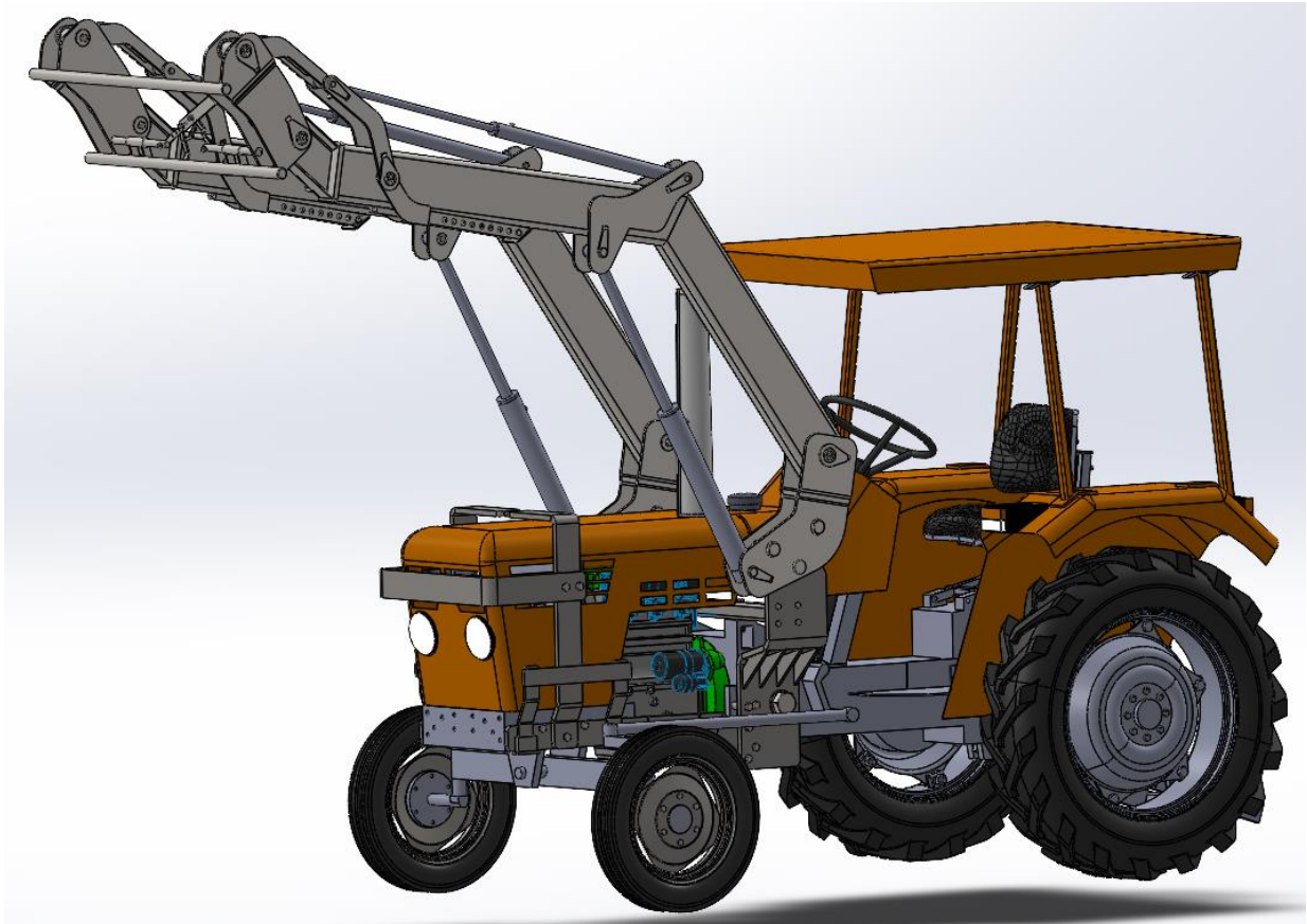
Slika 69. Sklop traktora i utovarivača kod maksimalnog kuta zakreta na maksimalnoj visini
