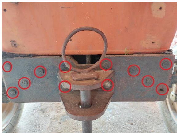
Slika 20. Prikaz uvrta za ugradnju prednjeg traktorskog utovarivača na traktor (prednja strana traktora)
