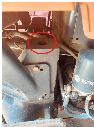
Slika 19. Prikaz uvrta za ugradnju prednjeg traktorskog utovarivača na traktor (dio ispod zaštitnog poklopcu motora)
