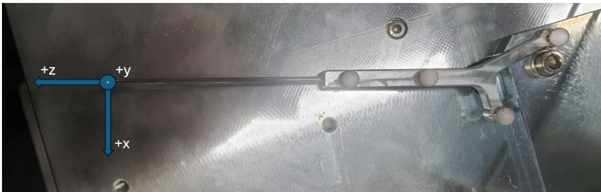
Slika 22. Transformirani koordinatni sustav stylus -a
