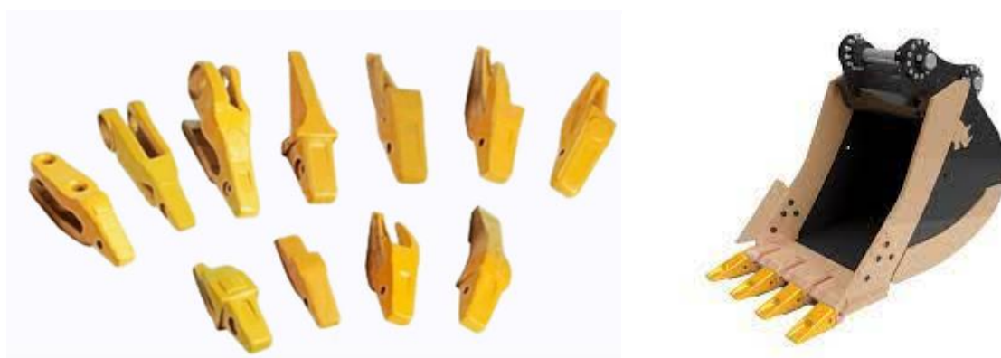
Slika 23. Različiti oblici zuba za bagere (lijevo) i lopata sa zubima (desno) [39]
