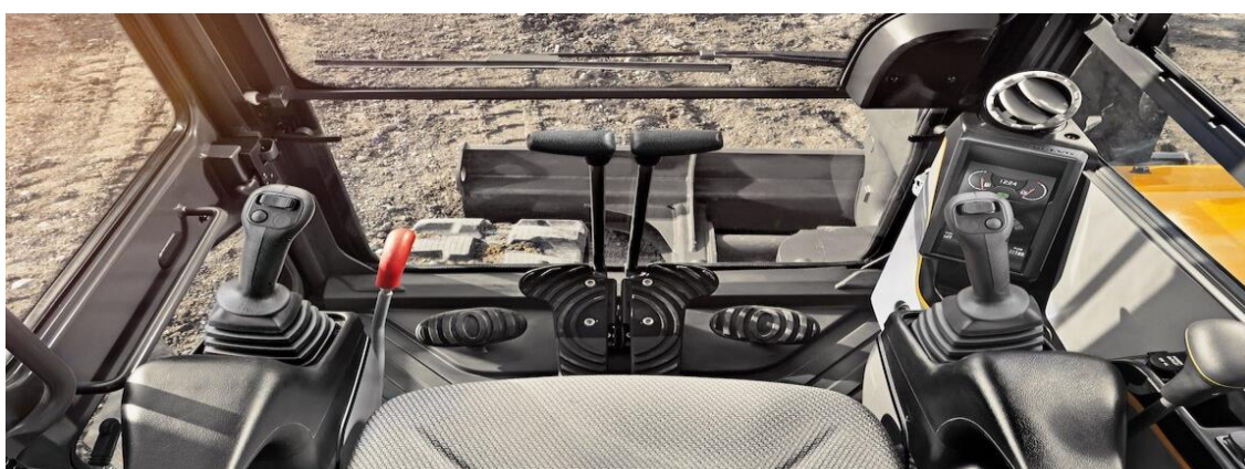
Slika 11. Unutrašnjost kabine bagera s pripadajućim upravljačkim uređajima i ostalim dijelovima [25]
