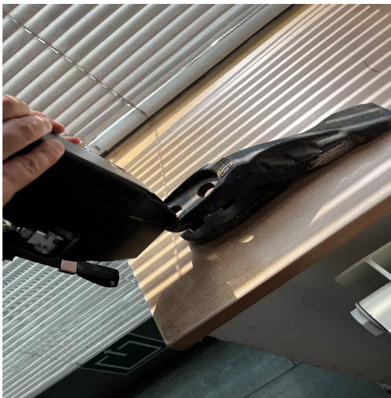
Slika 33. Tijek ispitivanja uzorka 2 LIBS metodom
