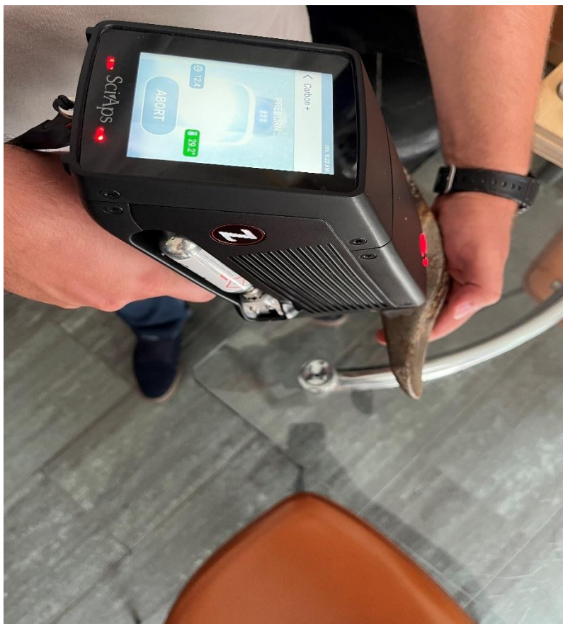
Slika 32. Tijek ispitivanja uzorka 1 LIBS metodom
