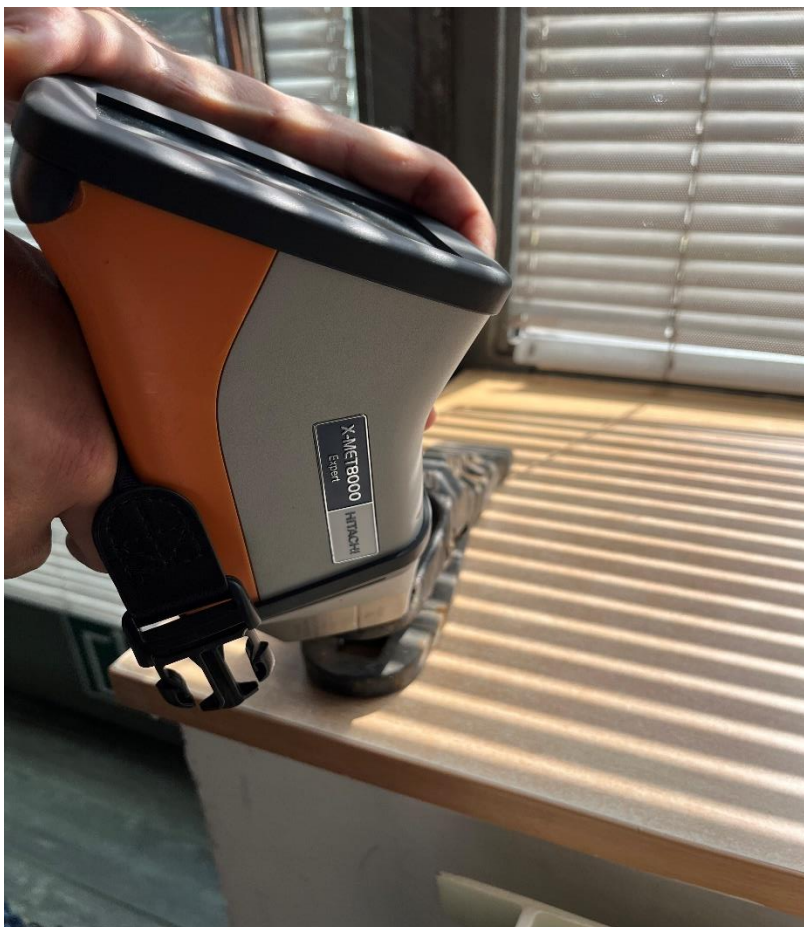
Slika 30. Tijek ispitivanja uzorka 2 XRF metodom
