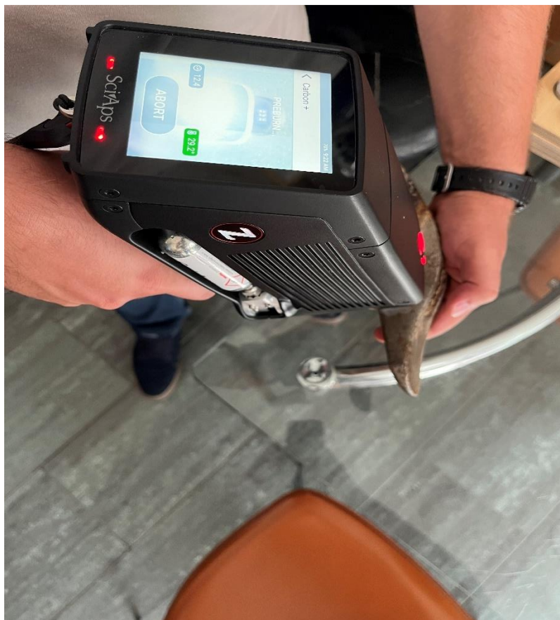
Slika 32. Tijek ispitivanja uzorka 1 LIBS metodom
