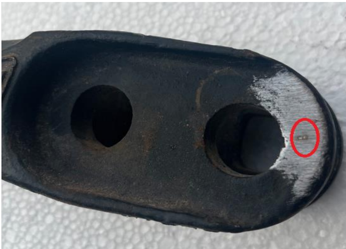
Slika 34. Trag LIBS ispitivanja na uzorku
