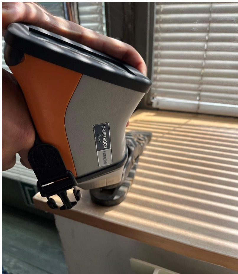
Slika 30. Tijek ispitivanja uzorka 2 XRF metodom
