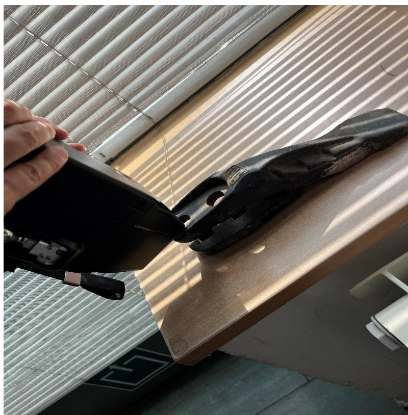
Slika 32. Tijek ispitivanja uzorka 1 LIBS metodom
