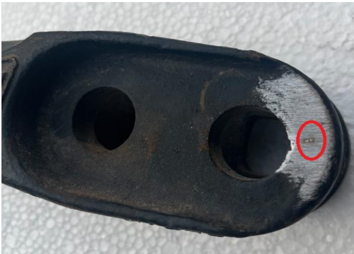
Slika 34. Trag LIBS ispitivanja na uzorku
