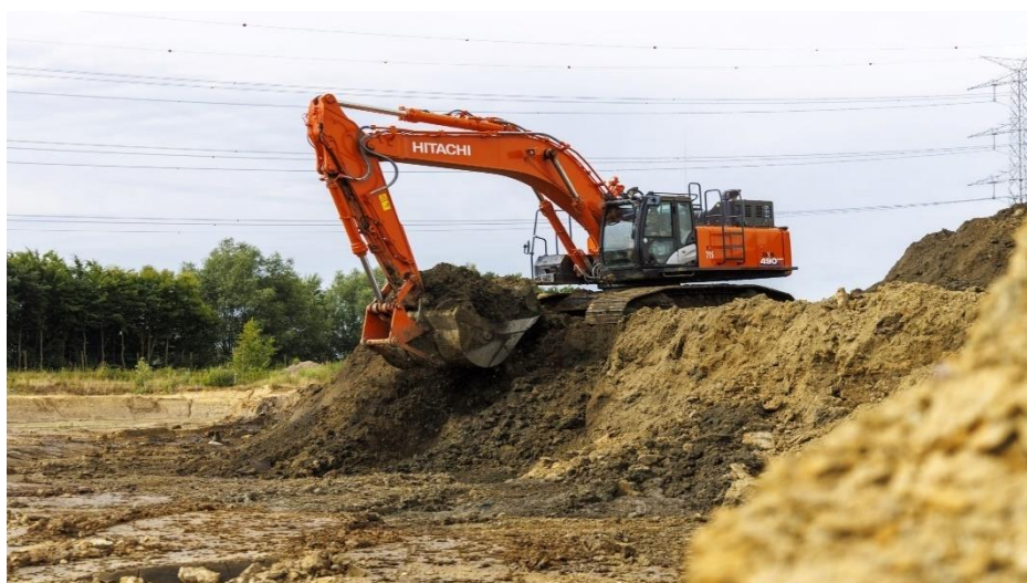
Slika 5. Hidraulični bager japanskog proizvođača Hitachi [12]
