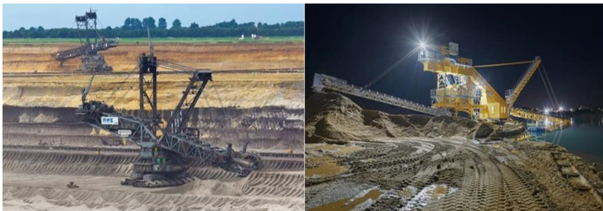
Slika 3. Bager vjedričar s kolom (lijevo) i lancem vjedrica (desno) [11,12]
