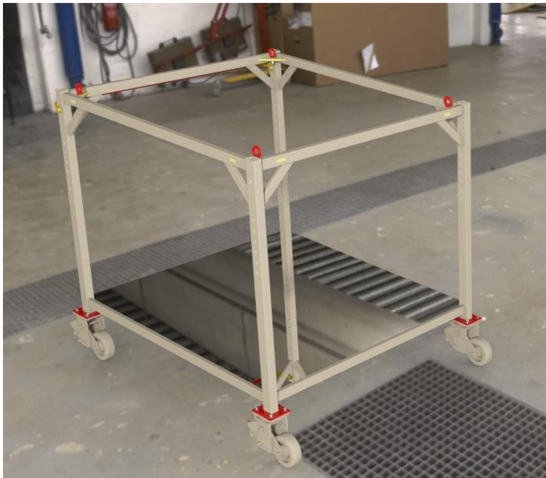
Slika 67. Konačni izgled mobilne stanice za vakuumsko impregniranje transformatora
