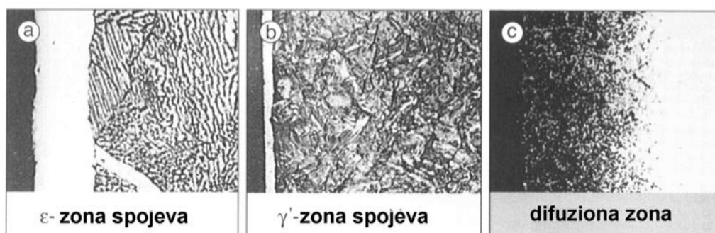
Slika 9. Mikrostruktura površinskog sloja nitriranog čelika [10]
