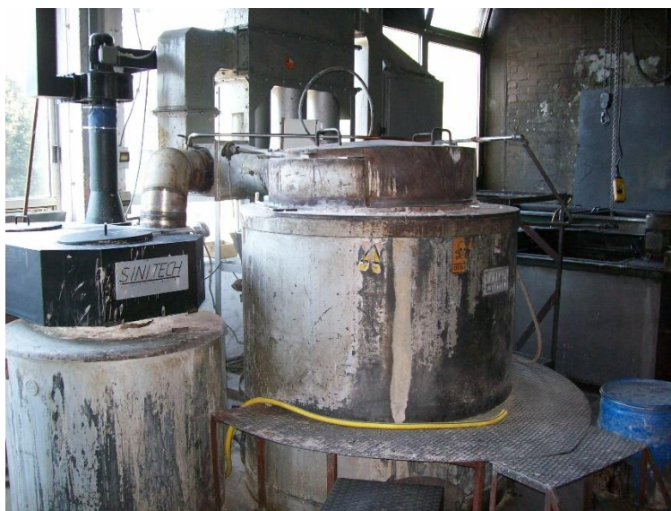
Slika 12. Spremnik za nitrokarburiranje u kupki TENIFER
