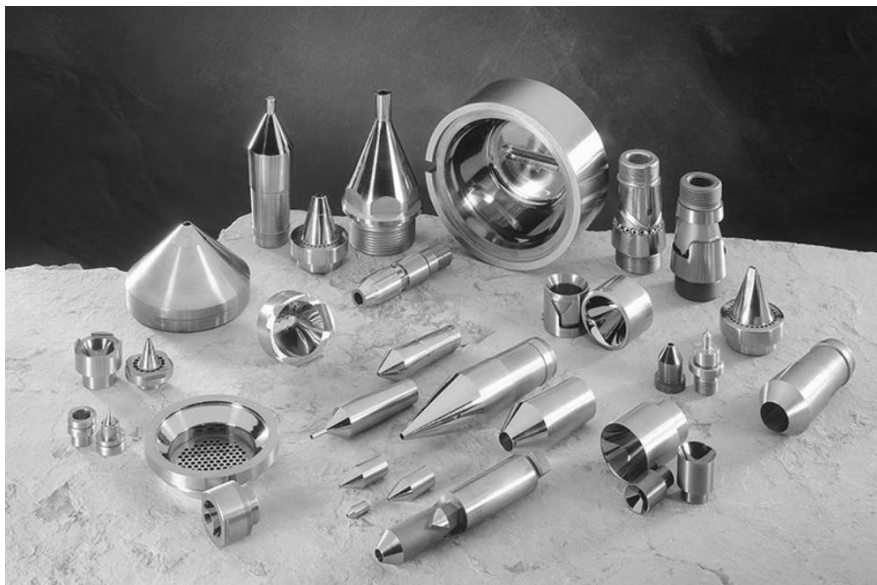
Slika 26. Borirani alati za ekstrudiranje [16]
