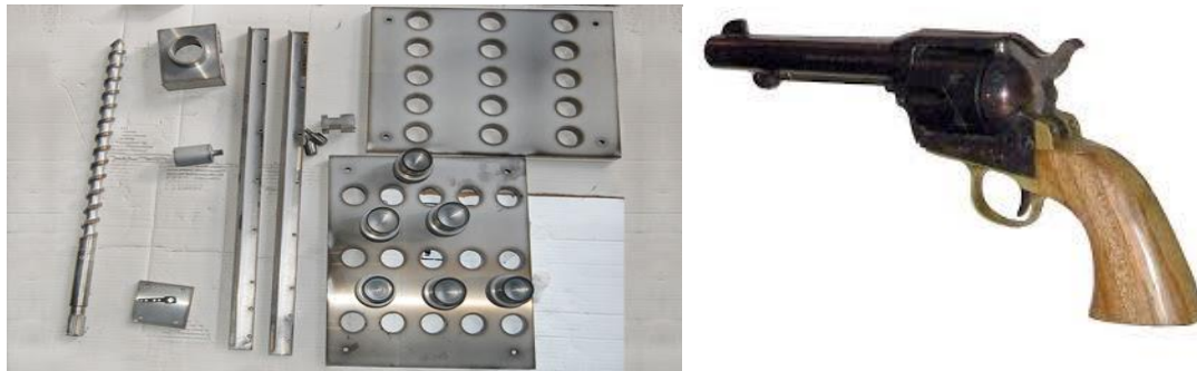
Slika 17. Primjer nitriranih i nitrokarburiranih dijelova
