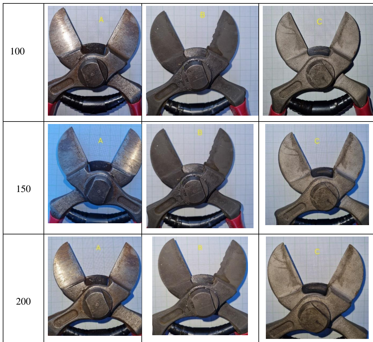
Tablica 5. Stanje oštrica škara u terenskom ispitivanju
