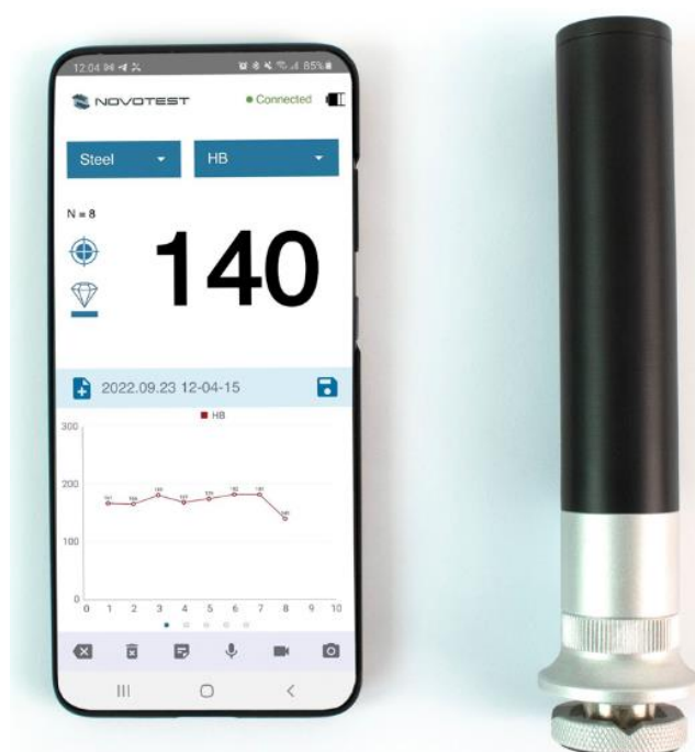
Slika 27. NOVOTEST uređaj za ispitivanje tvrdoće i aplikacija za očitavanje tvrdoće [17]
