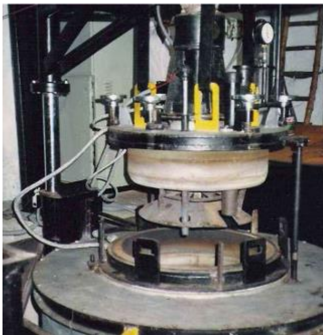
Slika 13. Spremnik za nitriranje u plinu
