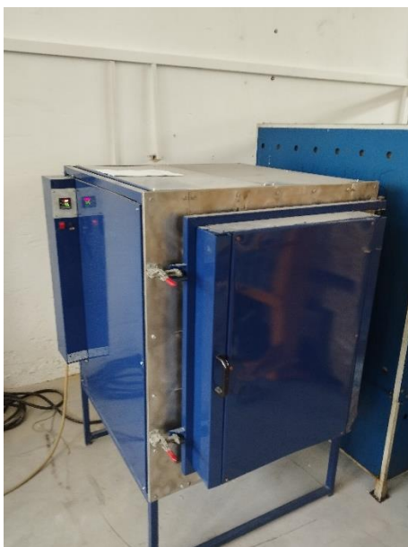
Slika 30. Komorna elektrootporna peć „Pika“
