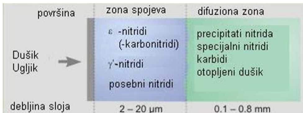
Slika 8. Debljina nitiranog sloja [10]
