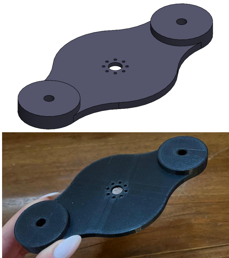
Slika 23. 3D model i print držača spremnika
