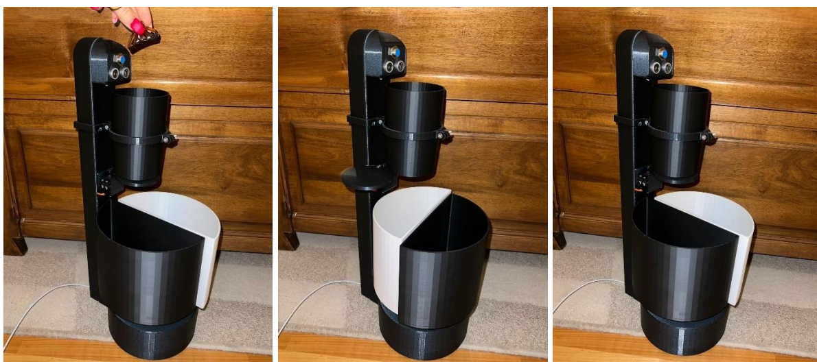
Slika 33. Umetanje plastičnog predmeta, rotiranje bijele posude, neutralni položaj
