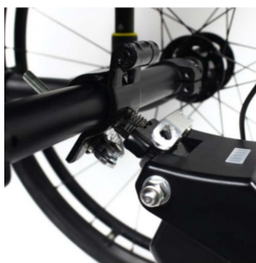
Slika 19 ChampDriver instalacijski nastavak [12]
