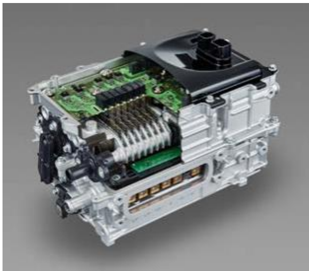
Slika 6 Jedinica za kontrolu snage
