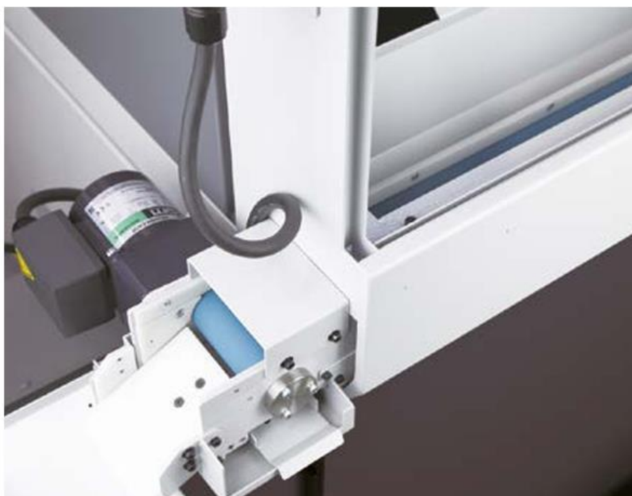
Slika 46. Konvejer za transport izradaka pogonjen elektromotorom [46]
