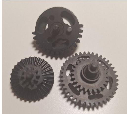
Slika 25. Primjerak dijelova zupčanog prijenosnika omjera 13,65 koji će biti korišten za referencu
