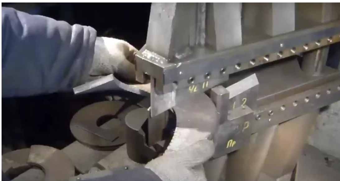
Slika 3. Izrada spirale pomoću pritiska
