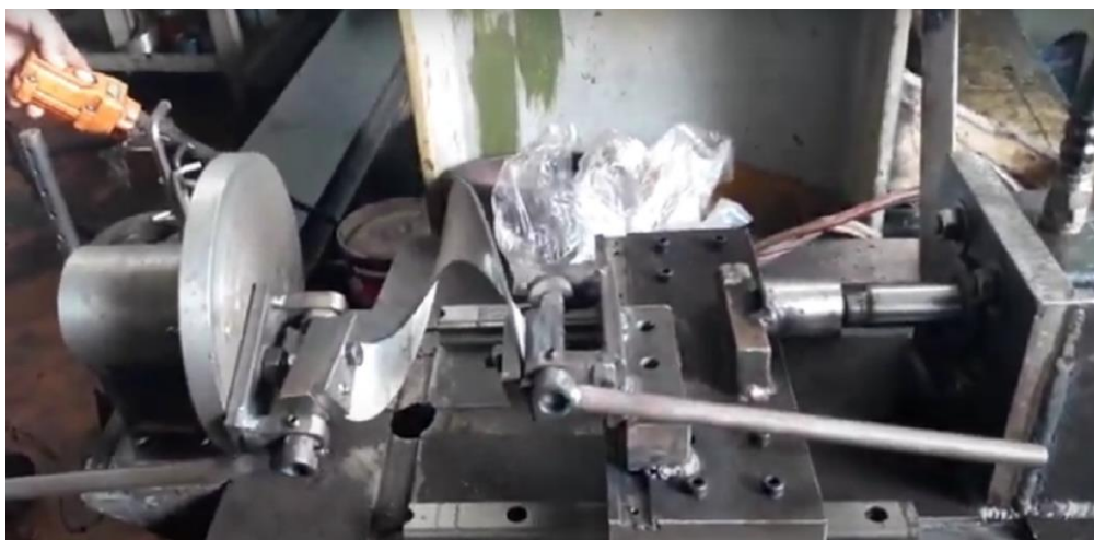
Slika 5. Razvlačenje lima pomoću hidrauličkog pogona
