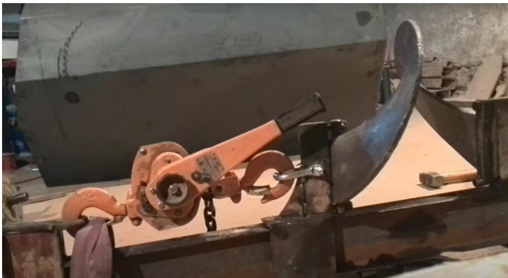
Slika 4. Razvlačenje lima pomoću ručnog pogona
