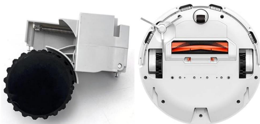
Slika 17. Donja strana Xiaomi Mi Robot Vacuum robota [7] (desno) i sklop pogona i ovjesa (lijevo) [8]
