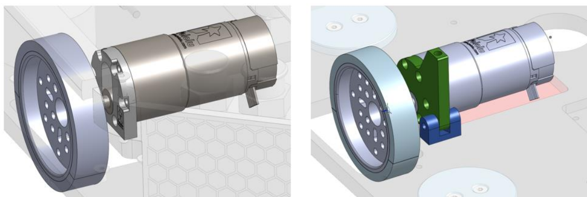
Slika 33. Stari prihvat motora na kućište (lijevo), novi prihvat (desno)
