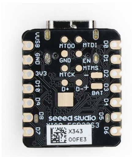
Slika 10. XIAO ESP32S3 mikrokontroler [9]
