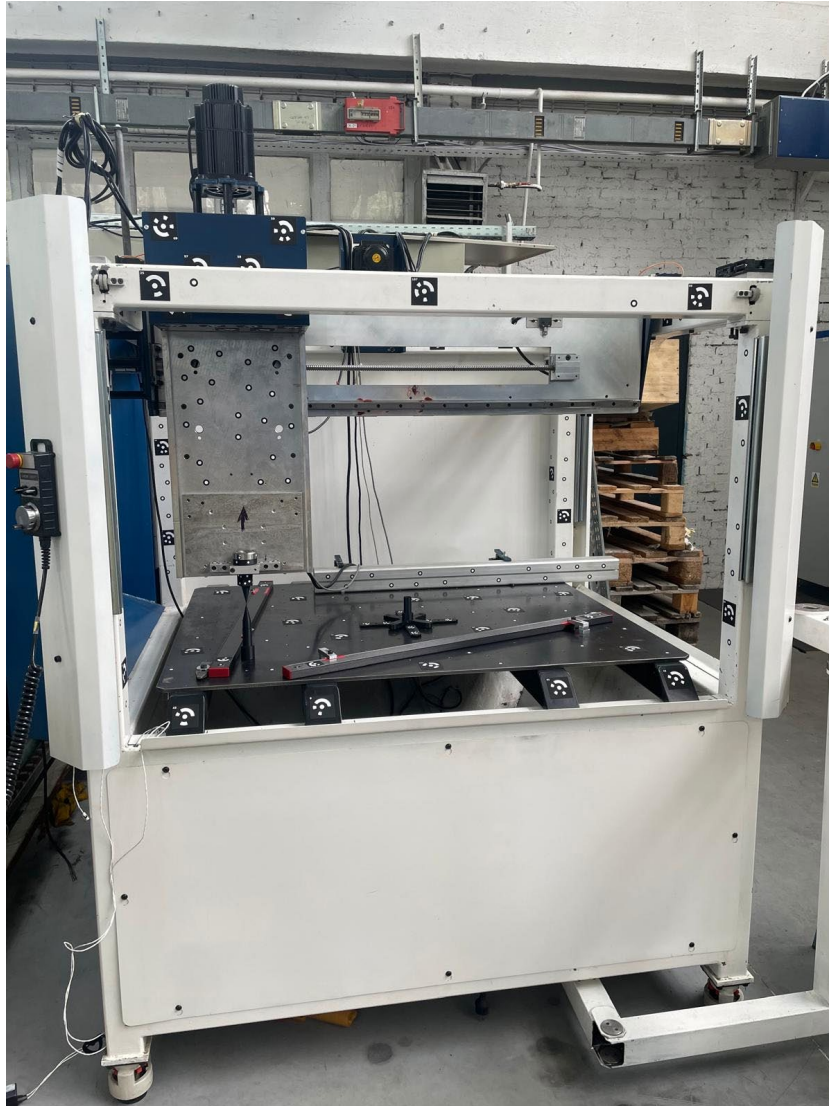
Slika 3.1 Numerički upravljani alatni stroj ADRISS
