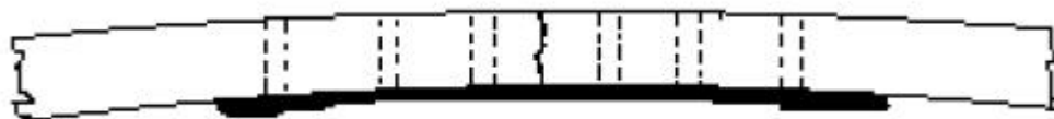
Slika 3: Namještanje pločice na unutarnju stranu ukrivljene kosti može opteretiti pločicu maksimalnom silom. [1]
