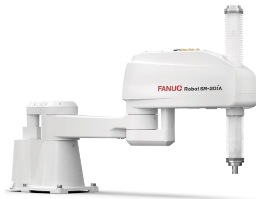
Slika 16. Shematski prikaz robota tipa SCARA [4]
