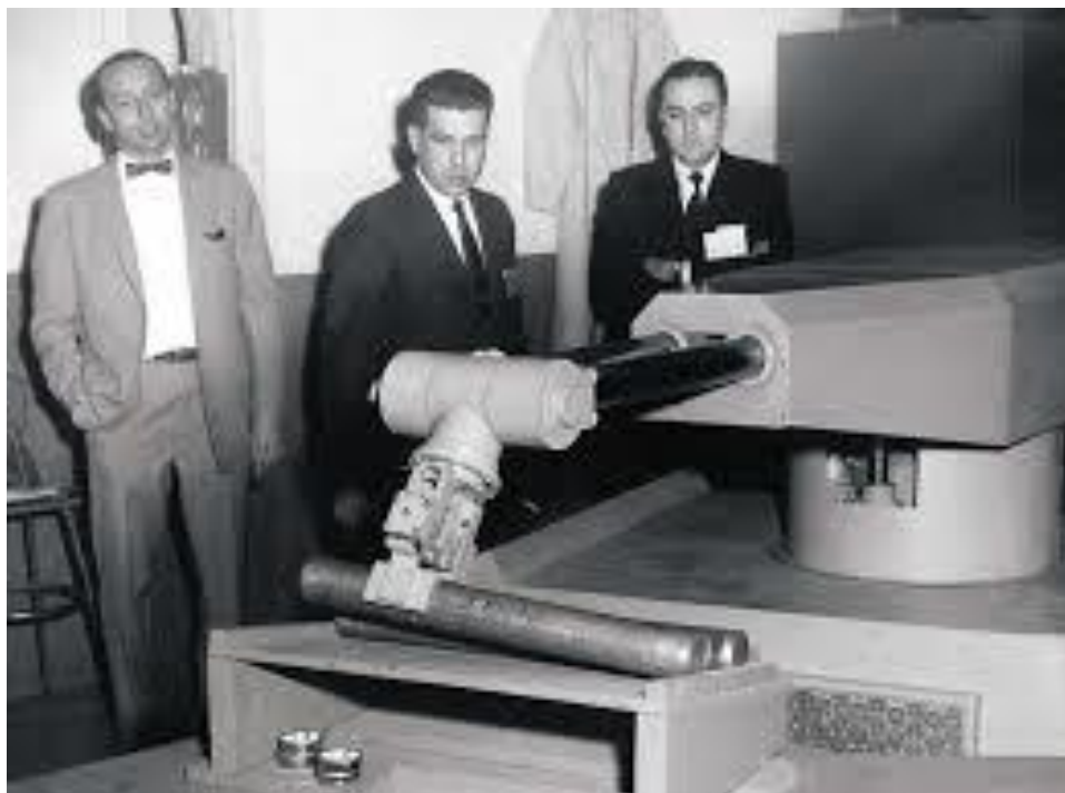
Slika 1. Unimate - prvi industrijski robot [5]
