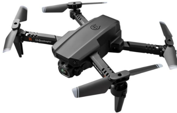
Slika 2: Dron kao primjer slabo prigušenog inercijskog sustava
