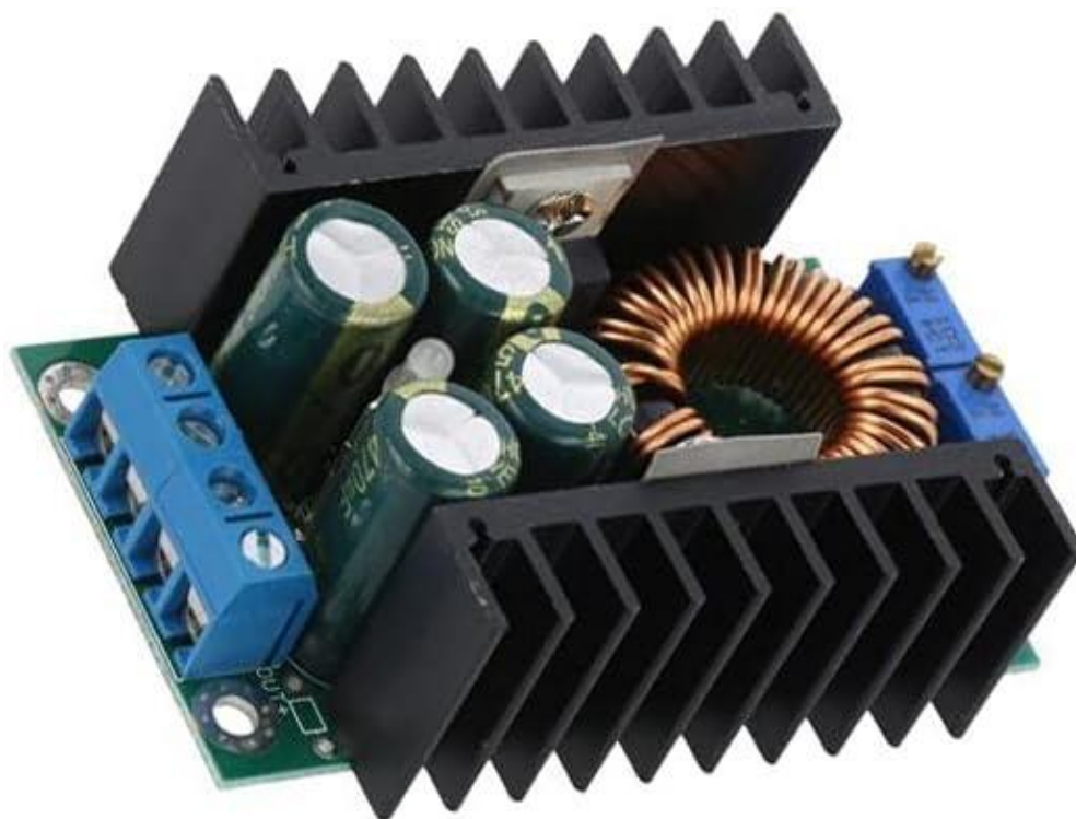
Slika 8 DC-DC pretvarač OKY 3498-4 [13]
