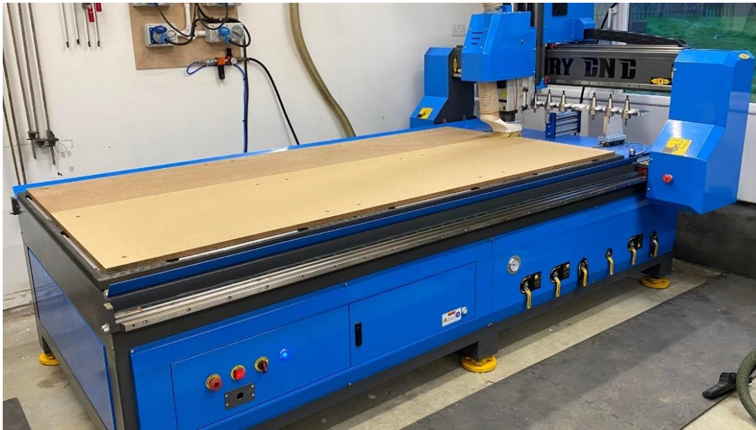
Slika 3. Stol CNC routera sa zamjenjivom MDF pločom [6]
