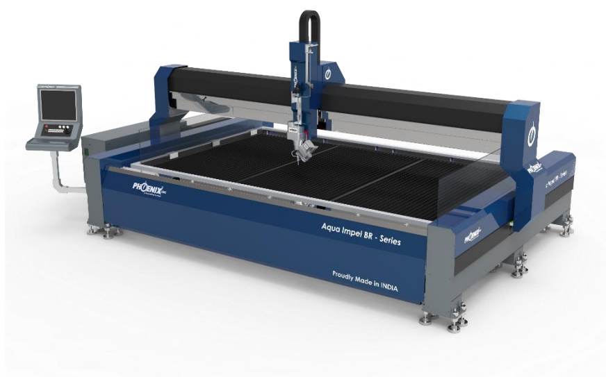
Slika 8. 5-osni stroj za rezanje vodenim mlazom [14]
