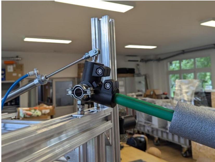
Slika 19. Spoj pneumatskog cilindra i fokusera
