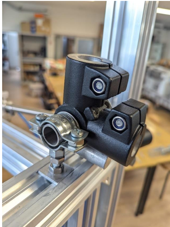
Slika 15. Spoj zgloba na konstrukciji
