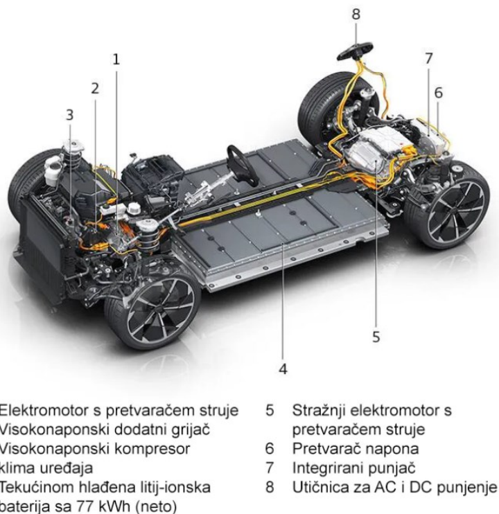
Slika 5. Građa Audi-a Q4 50 e-tron quattro [20]
