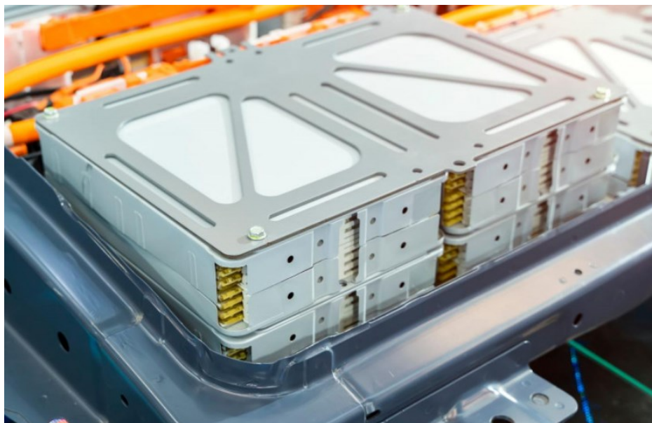
Slika 6. Prikaz litij-ionske baterije [24]
