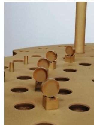
Slika 6. Prikaz uzoraka nakon prevlačenja prevlakom PACVD TiN
