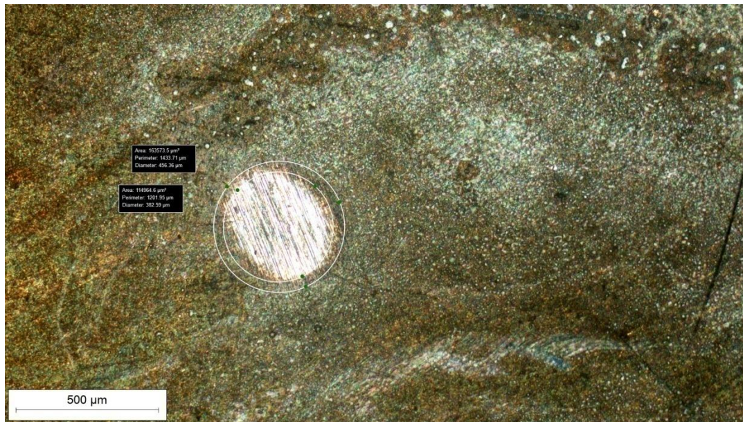
Slika 21. Dimenzije vanjskih i unutarnjih kružnica oko otiska nakon provedenog ispitivanja kalotesterom za uzorak D1
