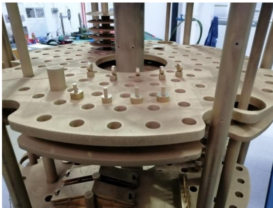
Slika 6. Prikaz uzoraka nakon prevlačenja prevlakom PACVD TiN
