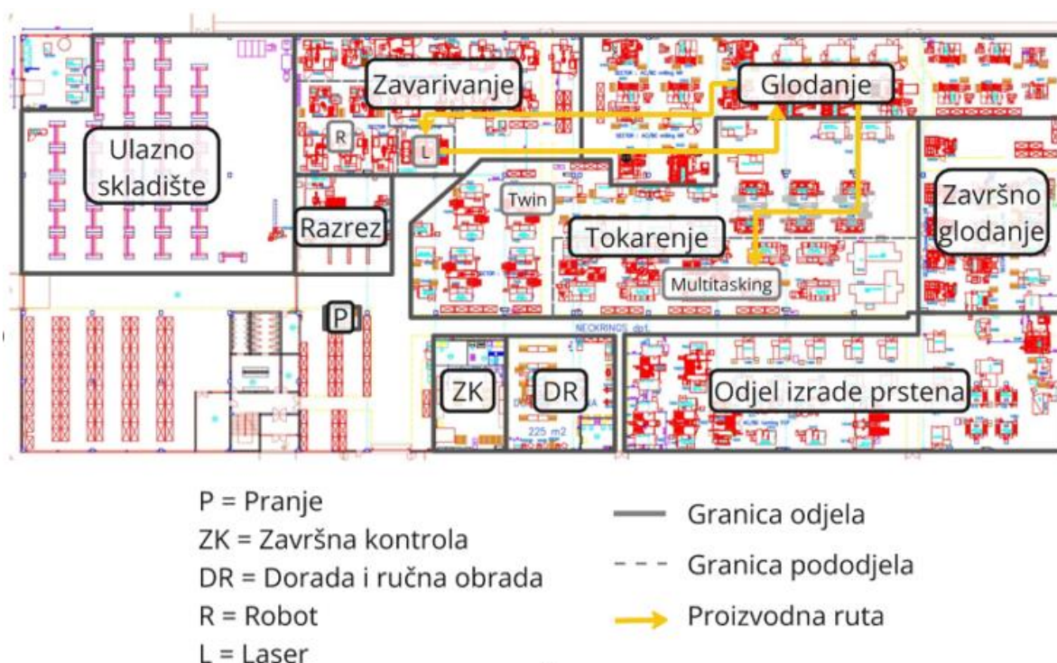
Slika 23. Prikaz prve proizvodne rute na nacrtu pogona
