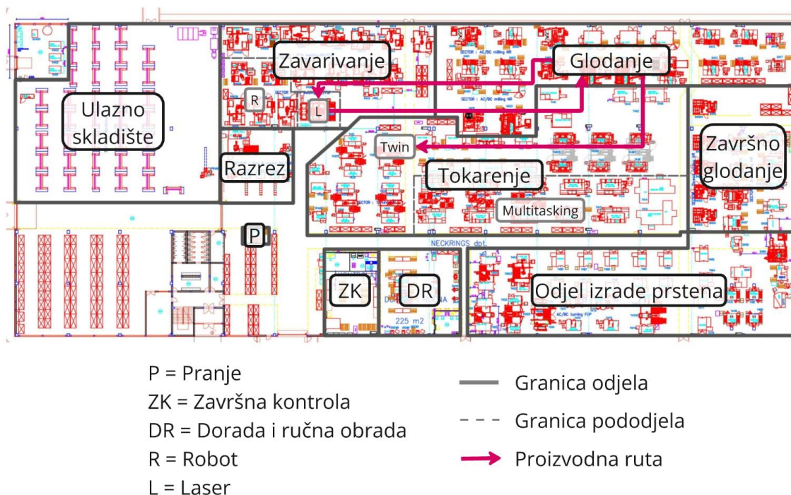
Slika 26. Prikaz četvrte proizvodne rute na nacrtu pogona
