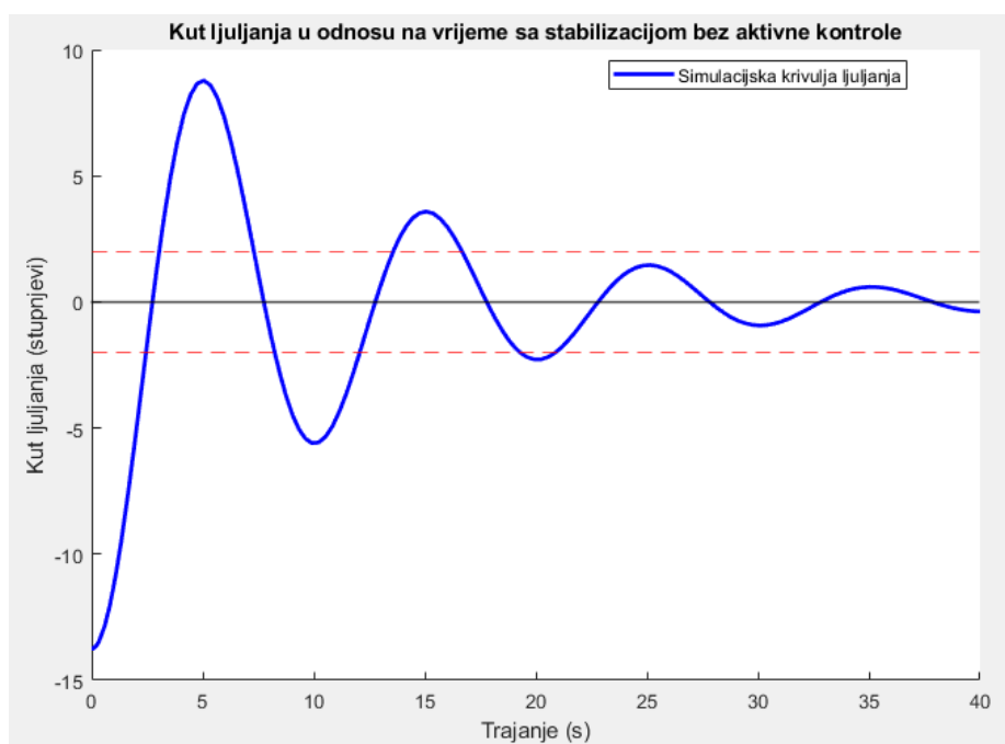
Slika 6. Prikaz kuta ljujanja broda u odnosu na vrijeme sa stabilizacijom bez aktivne kontrole
