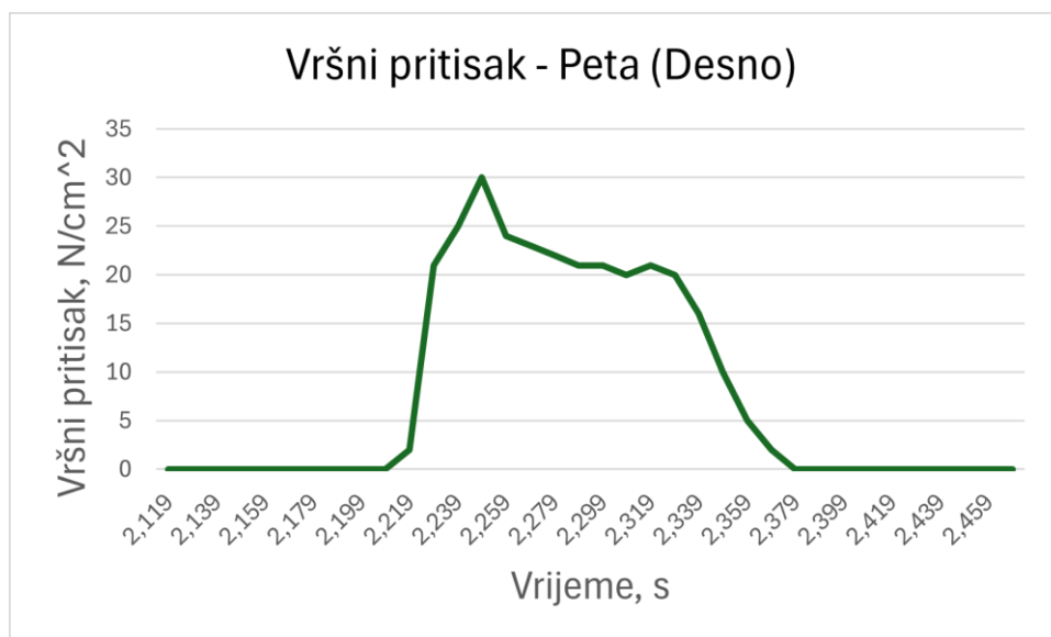
Slika 27. Dijagram vrijednosti pritiska u ovisnosti o vremenu pri prijehu na nogu kod spuštanja niz stepenice (peta desne noge)
