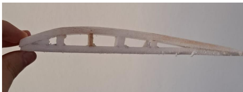
Slika 4.7 Unutarnja struktura krila
