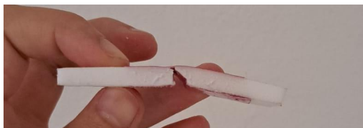
Slika 4.9 Fleksijski mehanizam zakretanja
