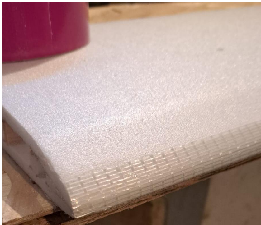
Slika 4.10 Krilo ojačano staklenim vlaknima
