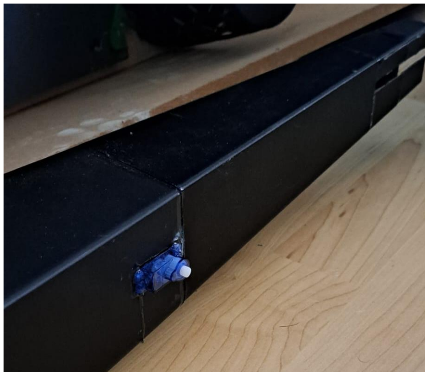
Slika 4.12 Servo motori nakon montaže i utor za vertikalni stabilizator
